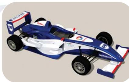
**Châssis** monocoque carbone norme F3 FIA 2008
